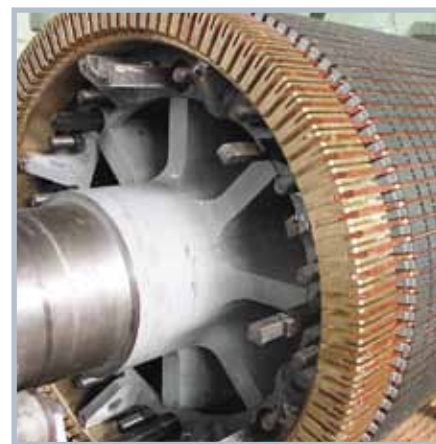
РОТОР АСИНХРОННОГО ДВИГАТЕЛЯ МОЩНОСТЬЮ 7100 КВТ В СБОРЕ
